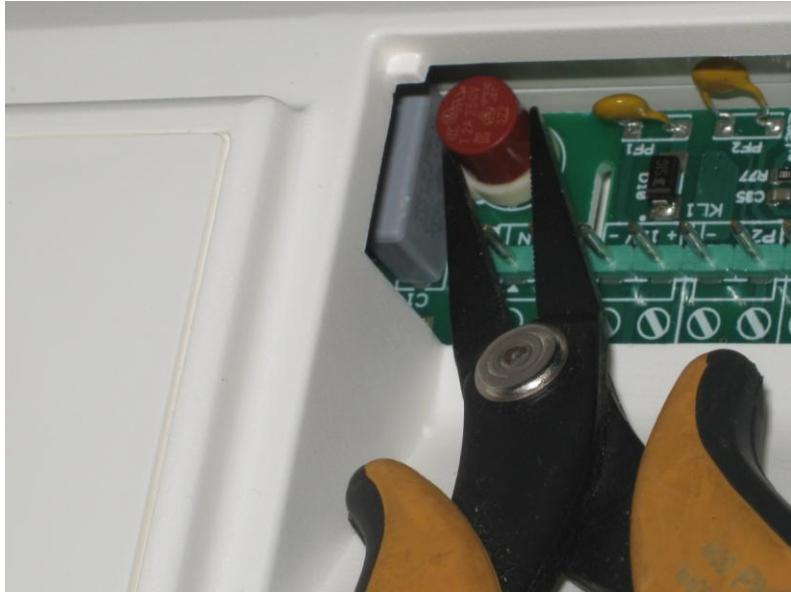
Σε περίπτωση αντικατάστασης της ασφάλειας, χρησιμοποιείστε την ασφάλεια που περιλαμβάνεται στη συσκευασία. Χρησιμοποιείστε ένα μυτοσίμπιδο για την αντικατάσταση της ασφάλειας (2Α) όπως φαίνεται στη φωτογραφία.
