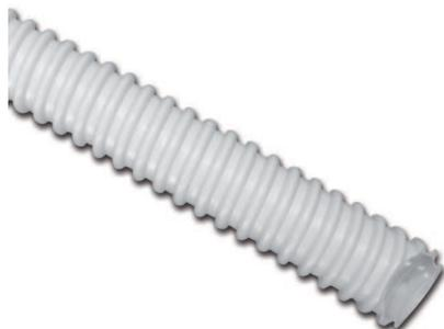
Εύκαμπτος ηλεκτρολογικός σωλήνας με ελικοειδή υποστήριξη για ελαφρές μηχανικές καταπονήσεις. Έχει θερμοκρασιακή λειτουργία από τους  $-15^{\circ}\text{C}$  έως τους  $+60^{\circ}\text{C}$ , προσφέροντας παράλληλα μεγάλη διηλεκτρική αντοχή και υψηλή αντίσταση μόνωσης. Κατασκευάζεται από πρωτογενείς πρώτες ύλες PVC U και P, με αυτόσβεση κατάταξης V0, σε γκρι χρωματισμό RAL 7035 και είναι ελεύθερος βαρέων μετάλλων (RoHS).
