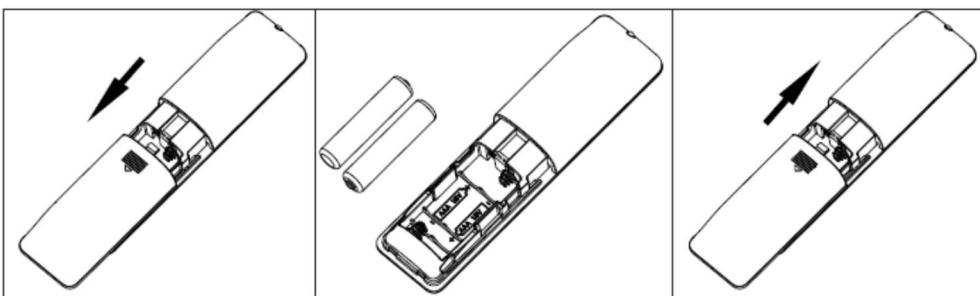
Um die Batterien herauszunehmen, den Deckel nach außen schieben und das Batteriefach auf der Rückseite der Fernsteuerung öffnen.
