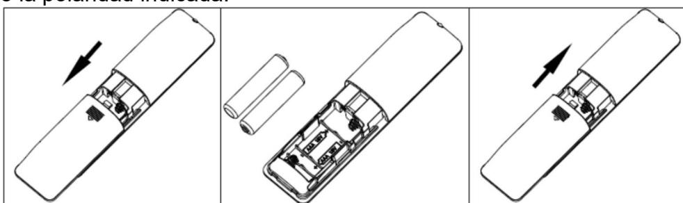
Para remover las baterías, abrir el compartimiento de las baterías colocado en la parte trasera del telemando, deslizando la tapa hacia afuera.
