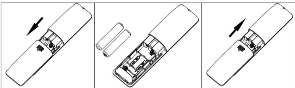
Chcete-li vyjmout baterie, otevřete kryt baterií umístěný na zadní straně dálkového ovladače.
