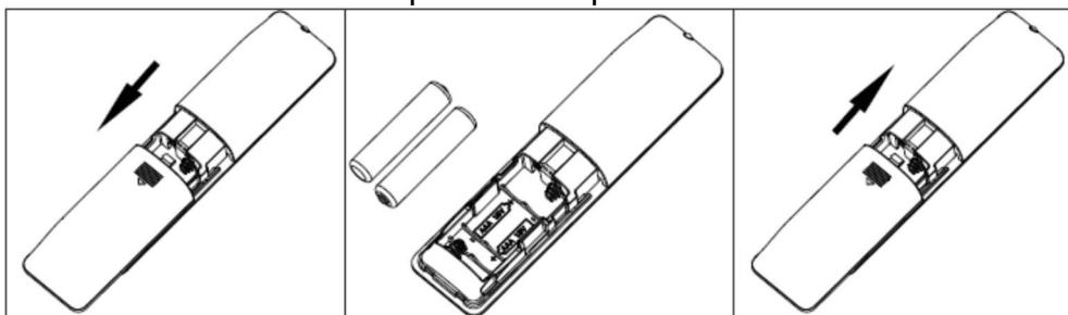
Per rimuovere le batterie, aprire il vano batterie posto sul retro del telecomando, facendo scorrere il coperchio verso l'esterno.
