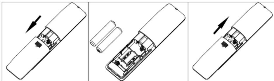
Pour enlever les piles, ouvrir le compartiment situé au dos de la télécommande en faisant glisser le couvercle.
