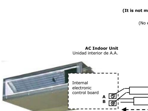
**NOTA:** En algunas unidades interiores no existe el conector A-B y en su lugar existen dos cables para la conexión del control remoto. Utilice dichos cables para conectar el bus A-B. Consulte el manual de usuario de su unidad interior para más información.
